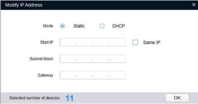
Figuur 2-4 - Interface voor wijziging van het IP-adres
